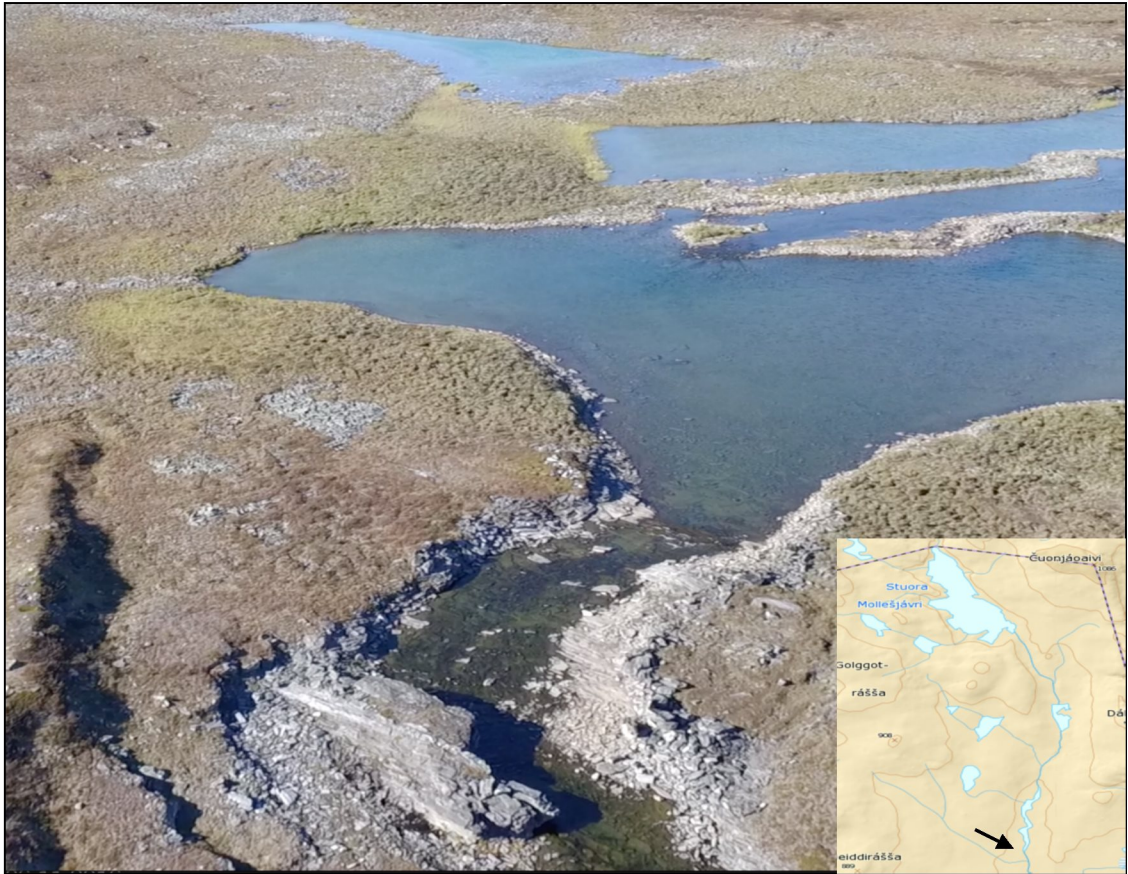
Figur 6. Bildet viser utløpet til de nedre lombolene (ca 7 km fra utløpet av Stuora Mollesjávri). Fra utløpet og nedover var vannføringen i Mollesjohka god da helikopterbildene ble tatt (24.08.2016) og med en vannføring på 3,69 \text{ m}^3/\text{s} ved målestasjonen. Elveløpet er herfra og nedover mer definert med en slik vannføring at fiskevandring er mulig (Foto: Troms Kraft).
