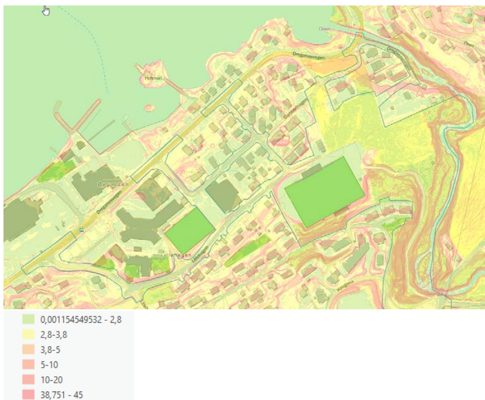
Figur 7-3: Kart som viser terrenghelningen i grader for området planlagt til idrettsformål. En helning 1:20 tilsvarer 2,8 grader.
