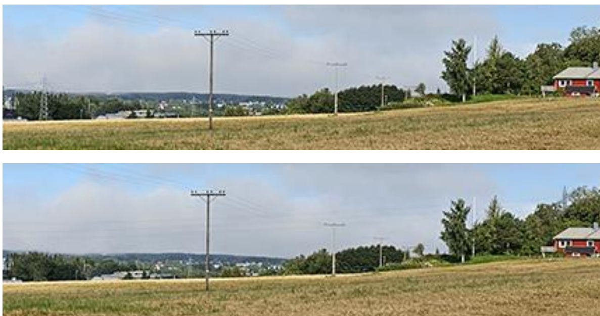
Figur 9-13: Utsnitt fra Figur 9-12, der det er tydeligere at masta til venstre i bildet er fjernet og en ny mast ført opp bak vegetasjonen til høyre i bildet.
