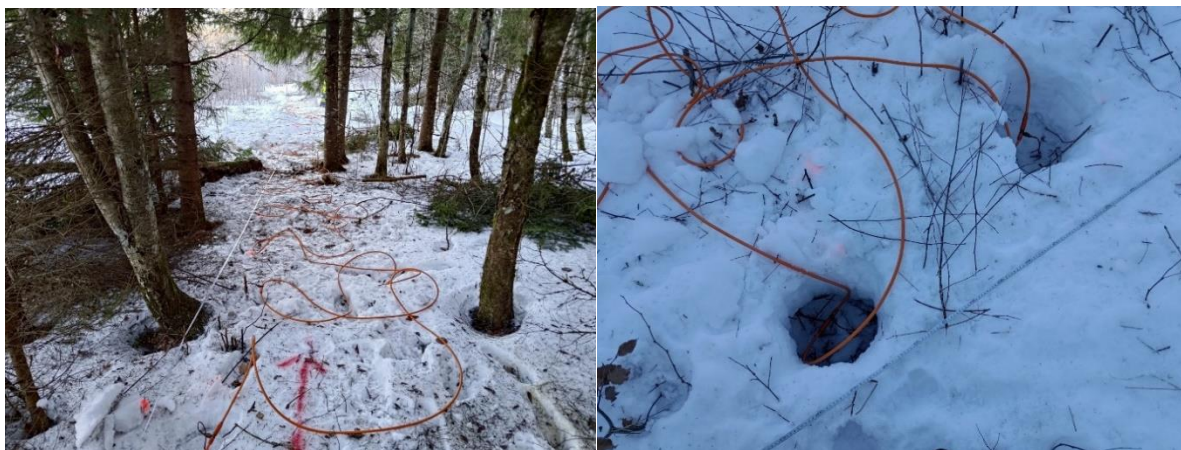
Figur 4: Venstre: Bilde som viser ERT-kabel lagt gjennom skogsområdet. Høyre: Nærbildet som viser hullene som ble gravet for hver elektrode for å oppnå god nok kobling til bakken.
