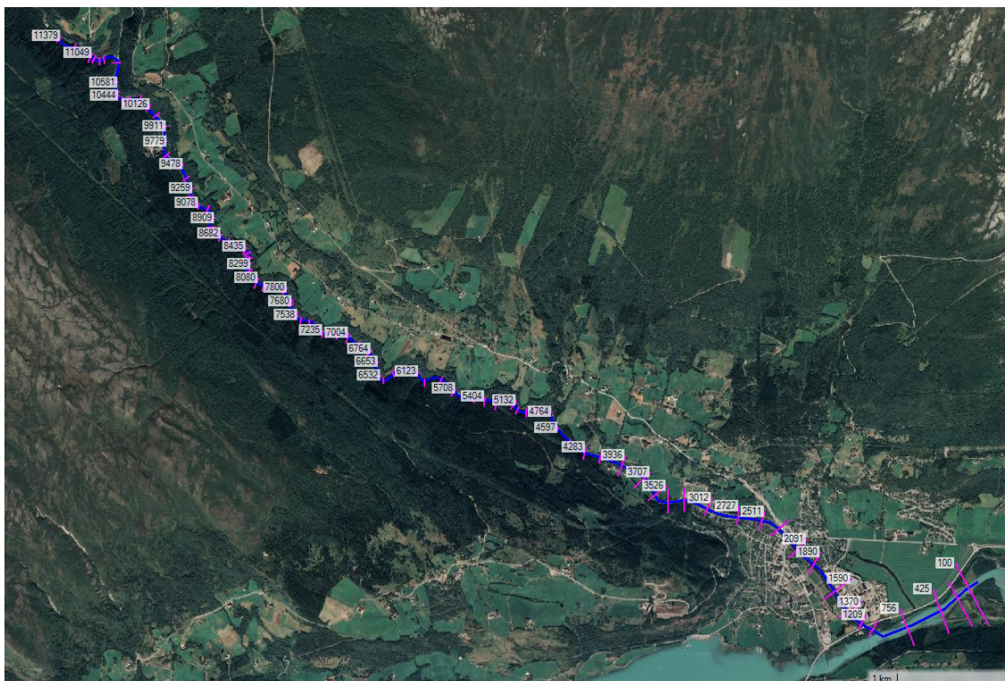
Figur 5-21 En-dimensjonalt modelloppsett i HEC-RAS med tilhørende tverrprofilnummering som viser avstand fra nederste profil i Otta.
