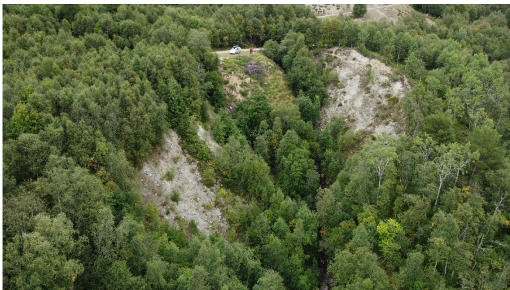
Figur A - 18 Dronebilde som viser skråning bestående av løsmasser ved punkt 12. Bildet er tatt fra vest mot øst. Lokalisering er vist i Figur A - 1.
