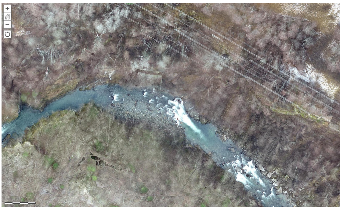
Figur 5-17 Dronefoto tatt høsten 2021 om lag 200 m sør for punkt 8, vist i Figur 5-2. Her kan man se akkumulerte masser i elveløpet som kan mobiliseres ved større flommer. Foto: NVE
