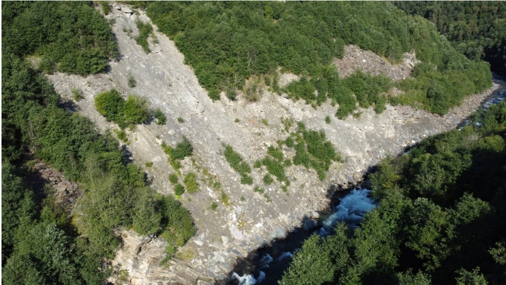
Figur A - 14 Dronebilde tatt ved punkt 10 som viser store mengder løsmasser i skråningen vest for elveløpet. Bildet er tatt mot nord-vest. Lokalisering er vist i Figur A - 1.
