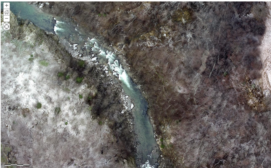
Figur 5-16 Dronefoto tatt høsten 2021 om lag 200 m nord for punkt 8, vist i Figur 5-2. Her kan man se akkumulerte masser i elveløpet som kan mobiliseres ved større flommer. Foto: NVE.
