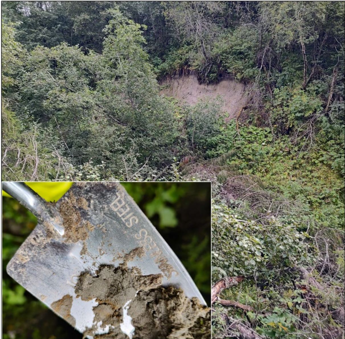
Figur 10. Laminert finsand i skredsår på østsiden av Bjørndalen. Offset ca. 3 m, og bredden på skredblokken er ca. 1 m.
