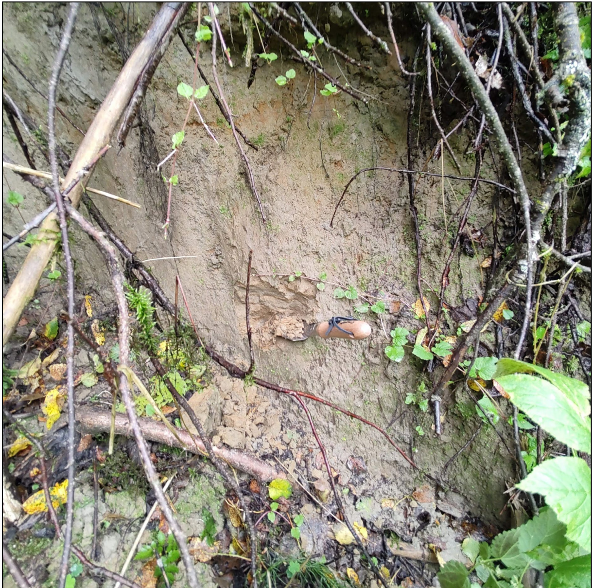
Figur 9. Eksponert finsand i utglidningsflate på vestsiden av Bjørndalen, nedenfor N10.
