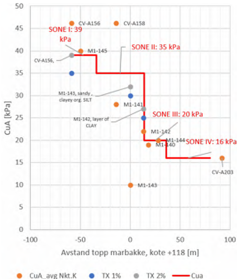
Figur 8-14: Figur for soner og valgte CuA-verdier for de ulike soner for Alternativ 2 øst i plaxis 3D beregning. Kilde: COWI AS
