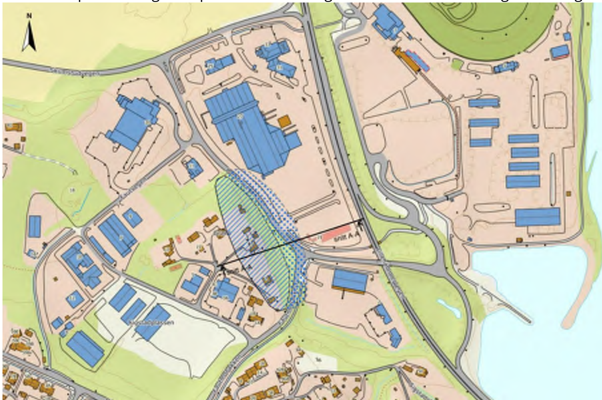
Figur 8-1: Snitt A-A i Biri vest. Løsne- og utløpsområde markert med blå skravering hhv. prikker. Blå farge indikerer at faresonen ikke er faregradsevaluert. Tiltaket er her vurdert til K1 da man har et lite tiltak som innebærer lite til ingen forverring. I tillegg vil utløpet heller ikke kunne nå frem til E6. . Kilde: COWI AS
