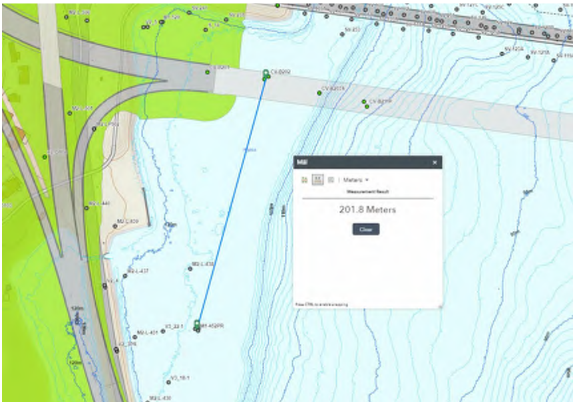
Figur 8-11: Utklipp fra GIS innsynsløsning med oversikt over fylling vest ved Alternativ 1 samt posisjon av borhull M1-452C der det er blitt utført CRS forsøk. Kilde: COWI AS
