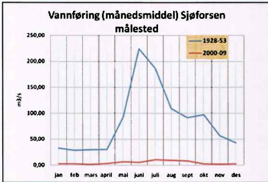
Figur 4 Målt vannføring ved stasjon 155. 6/12 Sjøforsen, ca. 1 km ovenfor utløpet av Nedre Røssåga kraftverk.
