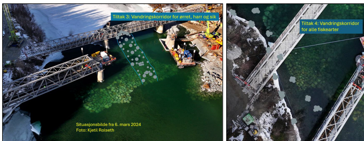
Figur 1: Dronefoto av tiltaksområdet med inntegning av planlagt tiltak med utlegging av stor stein i elveløpets dypål (venstre bilde) og langs sydvestre elvebredd (høyre bilde).
