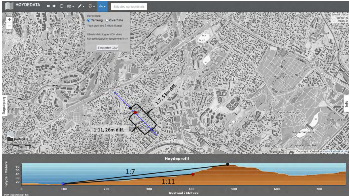
Figur 8-7. Snitt B. Dette er et område som må vurderes videre, her er det påvist sprøbruddsmateriale i nedre del av området.
