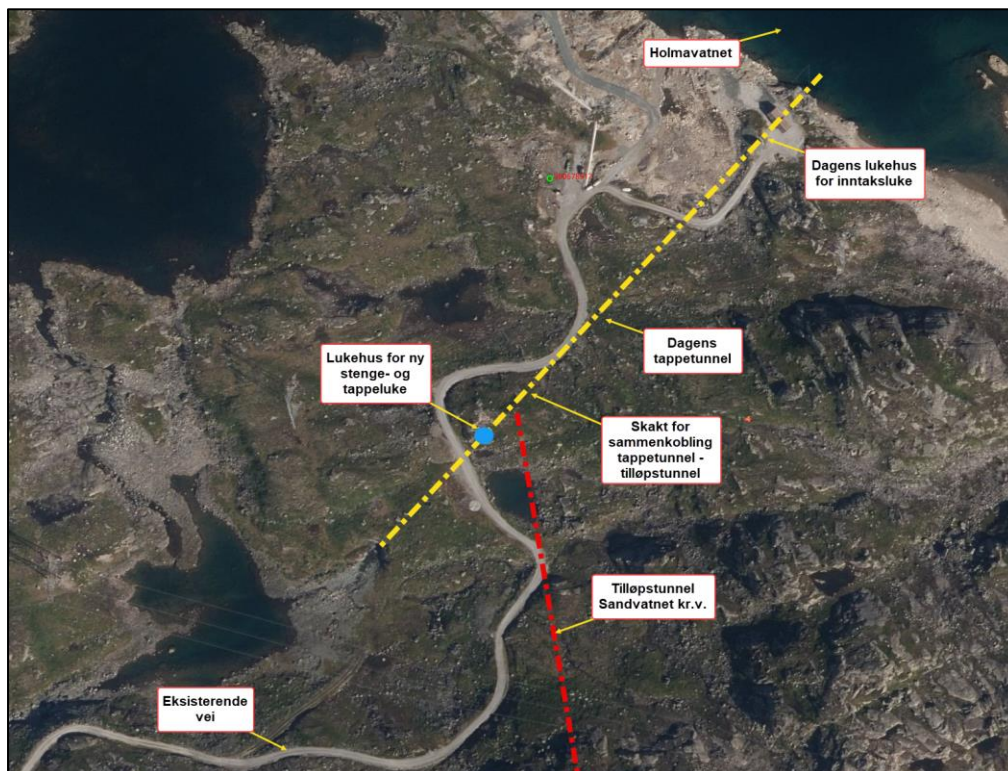
Figur 3-16: Sandvatnet kraftverk. Arrangement ved inntak Holmavatnet. Plan
