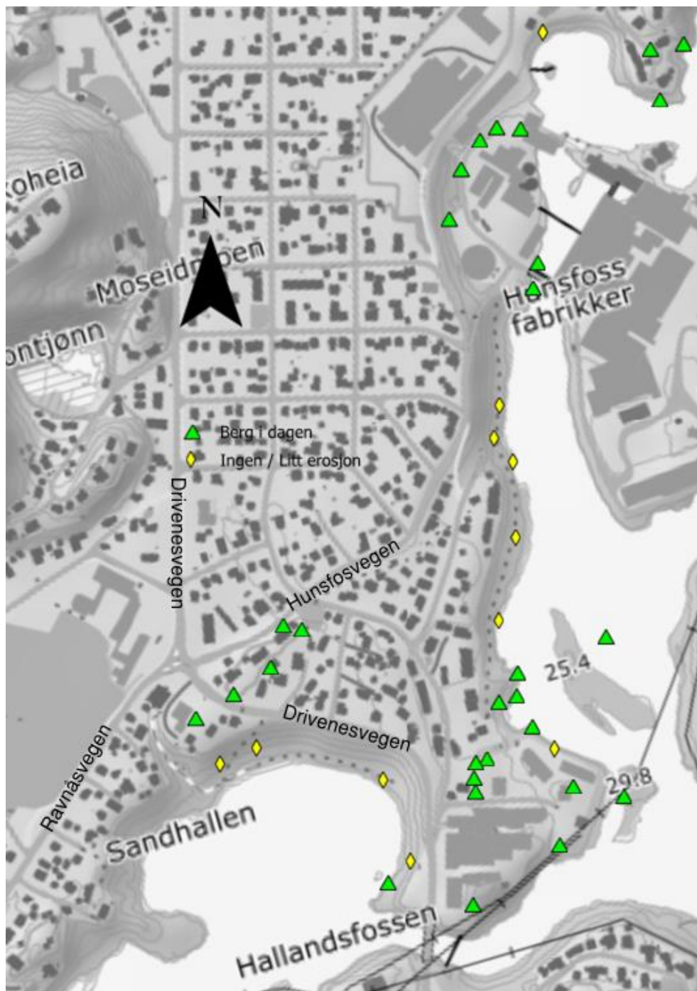
Figur 8 Registrering av berg i dagen og erosjonsforhold i Moseidmoen.
