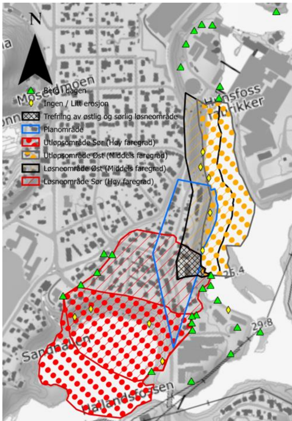
Figur 16 Trefning av det østlige og sørlige løsneområdet.
