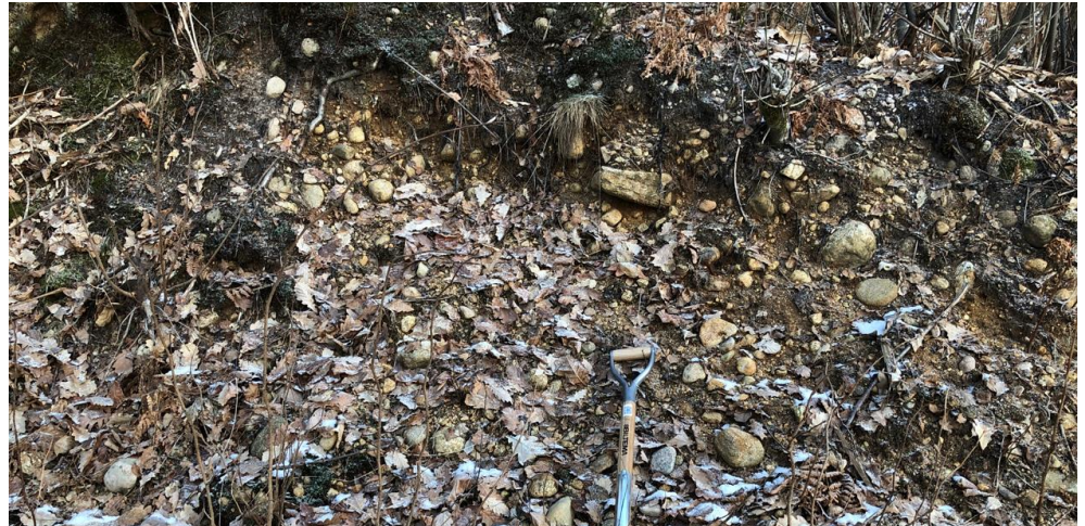
Figur 9 Friksjonsmasser i skråningsfot funnet ved befarings på sørlig skråning.
