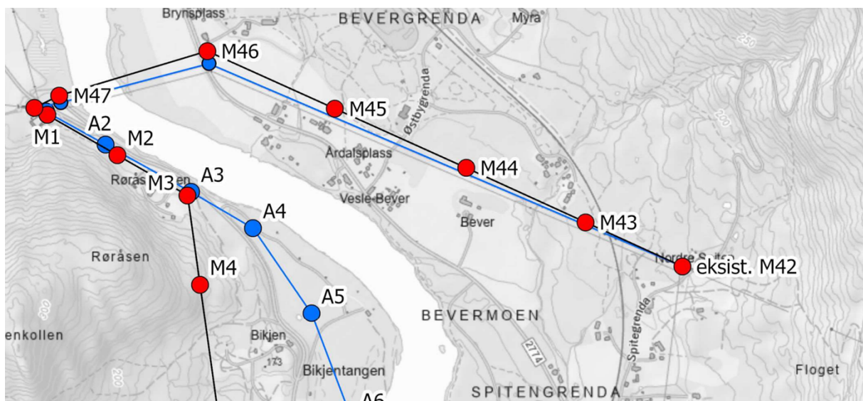
Figur 2: Ny trasé mellom Bevergrenda (M42) og Stengelsrud (M47). Konsesjonsgitt/eksisterende trasé er vist med blått, mens den omsøkte nye traseen er vist med sort strek og røde mastepunkter.
