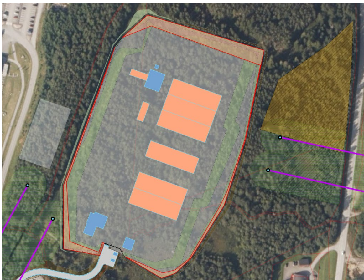
Figur 9 De røde polygonene i utkanten av stasjonen viser utvidet stasjonsareal innenfor stasjonsgjerdet.
