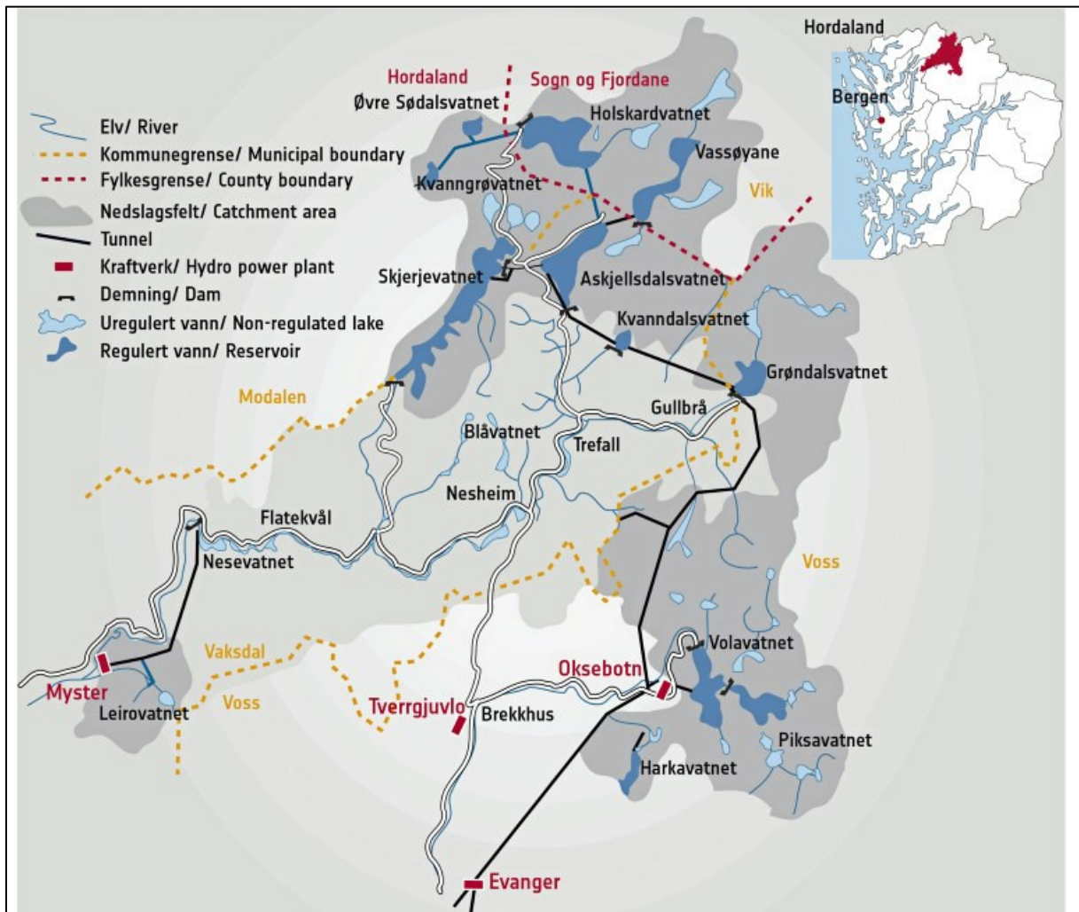
Figur 3. Kart over reguleringane i Eksingedals- og Teigdalsvassdraget til Evanger kraftverk (frå BKK).
