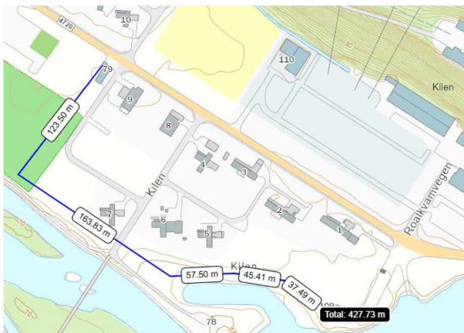
Figur 3-6: Grov skissering av kabeltrasé for nettilknytning.
