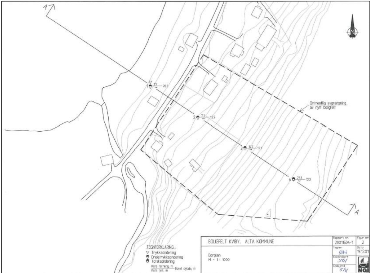
Figur 3-1 Utklipp av borplan hentet fra rapport 20011504-1 «Boligfelt Kviby, Alta kommune – grunnundersøkelser og stabilitetsvurderinger».
