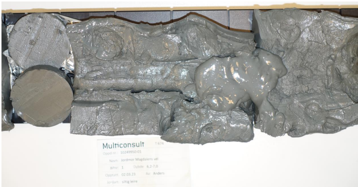
Figur 4-2: Kvikkleire hentet fra 6,2-7 meter i borpunkt 1.
