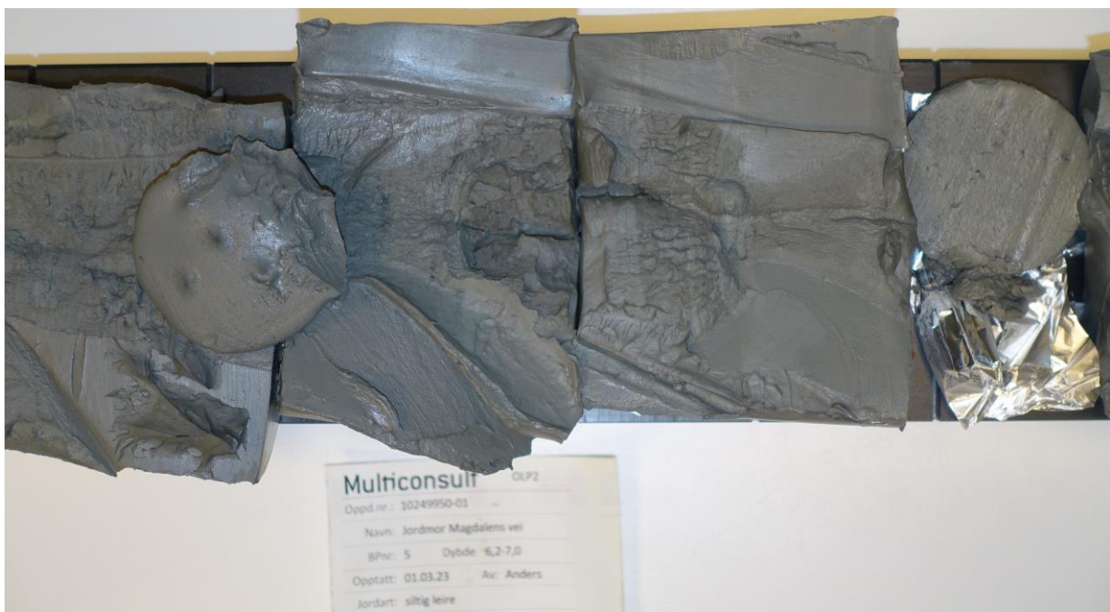
Figur 4-3: Leire hentet fra 6,2-7 meter i borpunkt 5.
