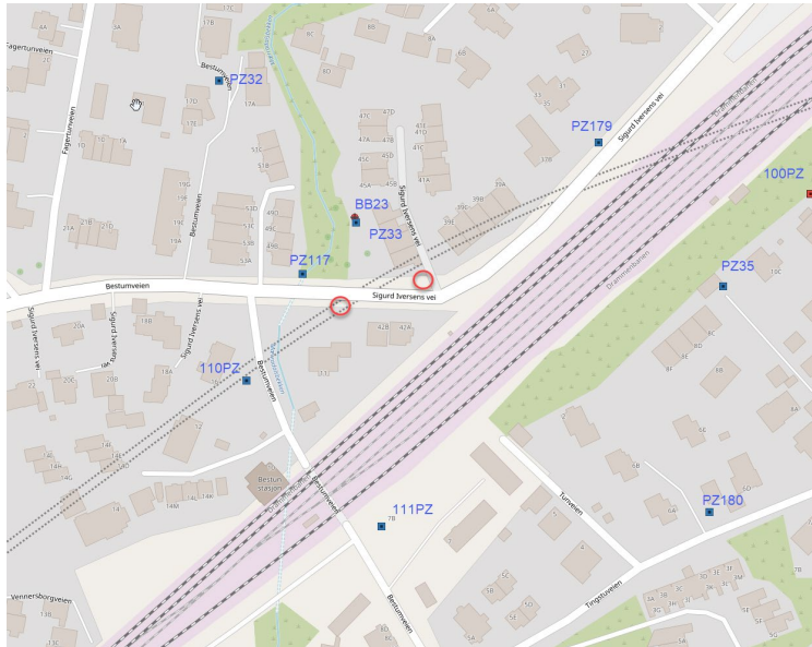
Figur 4-3. Elektriske poretrykkmålere i området. De to sirklene viser forslag på to nye poretrykkmålere
