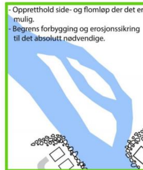
Fig. 7 Hovedprinsipp for miljøvennlig erosjonssikring – ikke mer en absolutt nødvendig
