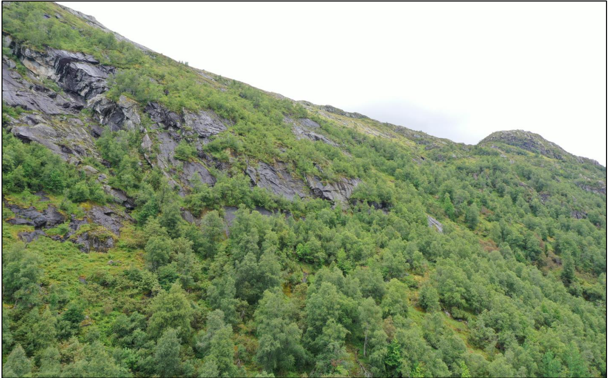
Figur 9: Dronebilete tatt ved Hagebakkane, ovanfor Hatlestad mot nordaust. Fjell i dagen kan observerast som mindre hamrar i øvre del av fjellsida, og som fjell i dagen grunna eit tynt lausmassedekke. Berggrunnen sprekk hovudsakleg opp parallelt med fjelloverflata. Typisk sprekkavstand er kring 1-2 m. Oppe til venstre kan er det observert eit relativt fersk skredsår grunna steinsprang.
