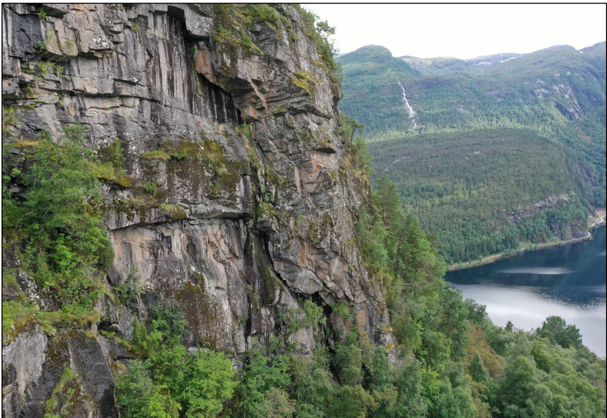
Figur 46: Dronebilde som viser område med potensiale for steinskred langs Hellebustkletten. Estimert losnevolum vil vere kring 3000 – 4000 m 3 .
