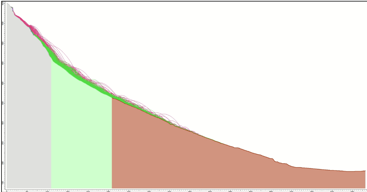
Figur 37: Resultat frå steinsprangsimulering langs profil 5 med rigid body ..
