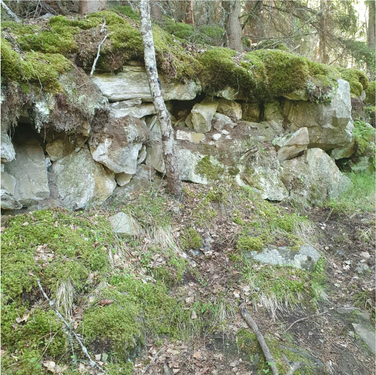
Figur 25. Typisk løsneområde for steinsprang i område A. Løsneområdene karakteriseres av små spredte skrenter over hele fjellsiden.
