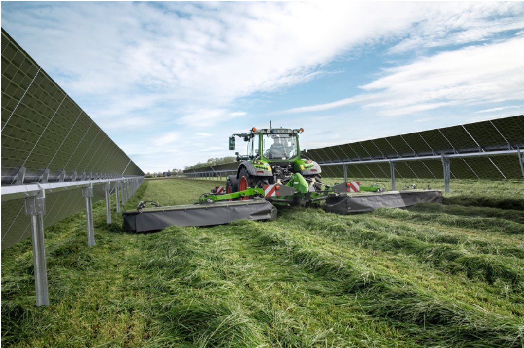
Figur 1-2 Typisk agrivoltaisk solkraftverk med følgestruktur og 1 panel i portrett. Kilde: AgriSolar: https://agrisolareurope.org/article/baywa-r-e-secures-e6-5-million-eu-funding-for-agri-pv/
