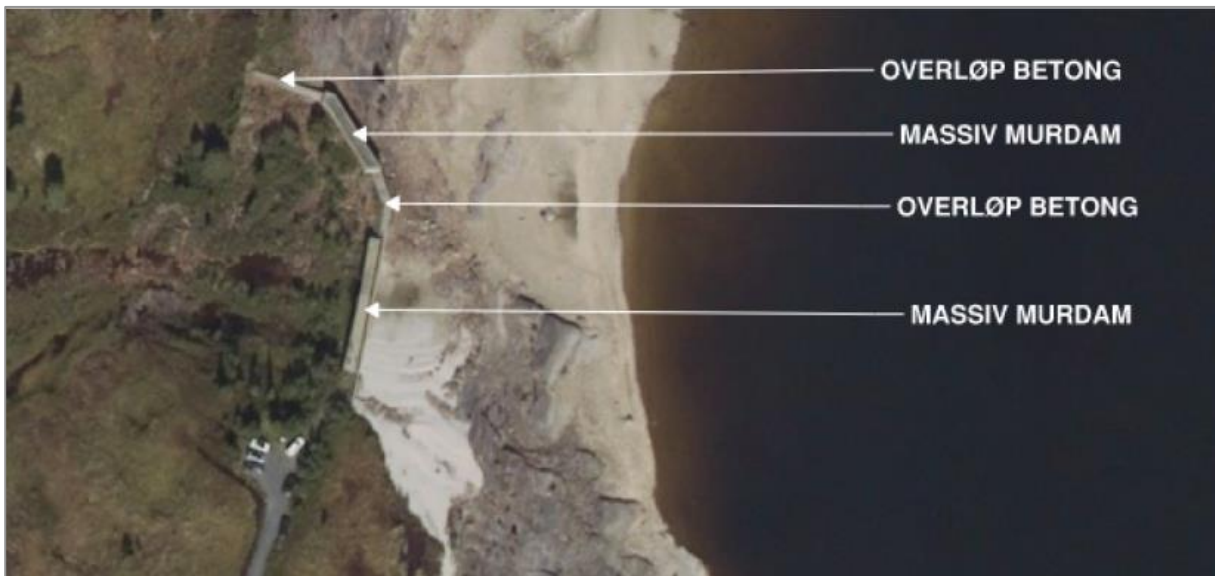
Figur 1.2 Kart over eiendommen, med angivelse av de ulike delene av dammen. Figur fra TrønderEnergi Kraft AS
