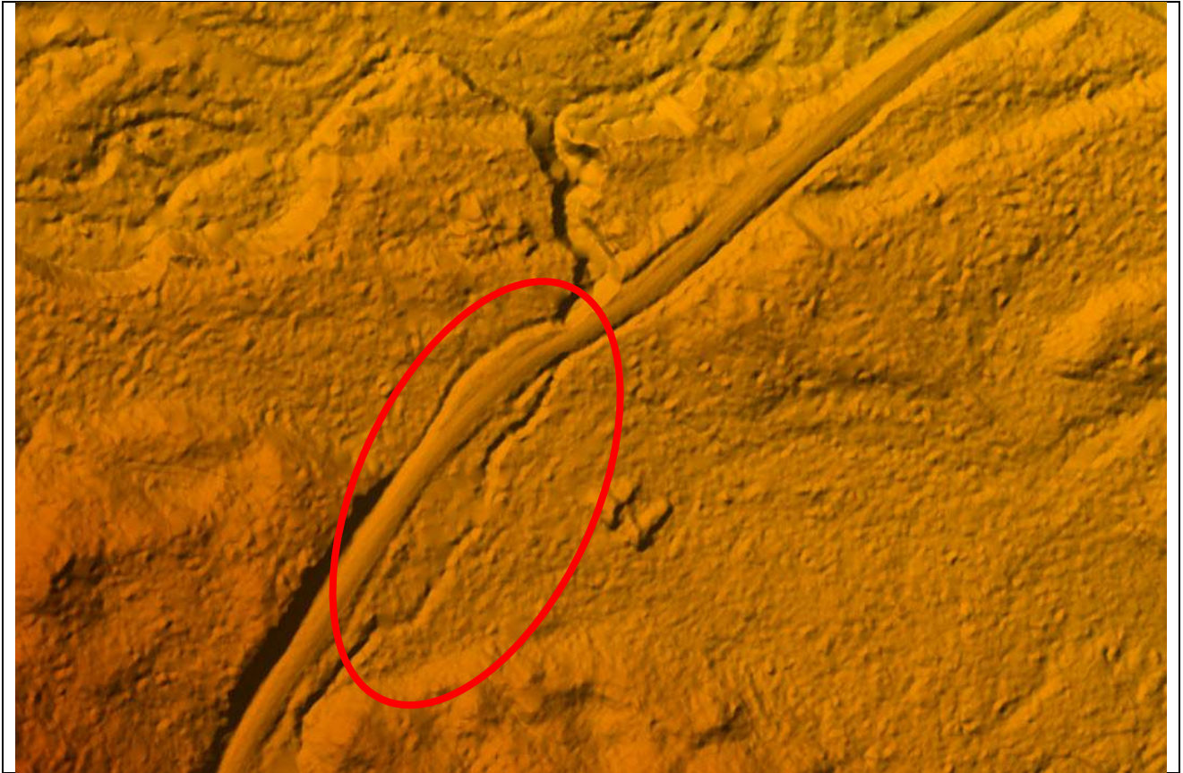
Figur 15: Utklipp fra terrengmodellen som viser at bekkeløpet ikke er godt definert over en lengre strekning. Dette fører til underestimering av bekkeløpets kapasitet og en overestimering av det oversvømte området
