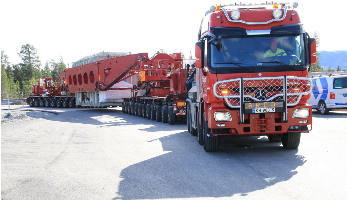
Figur 8. Bildet viser Statnetts transport av 420 kV transformator til Skillemoen transformatorstasjon i Alta i 2020. Tilsvarende transport vil bli utført til Hyggevatn transformatorstasjon. Transportens totale lengde er 72 m.
